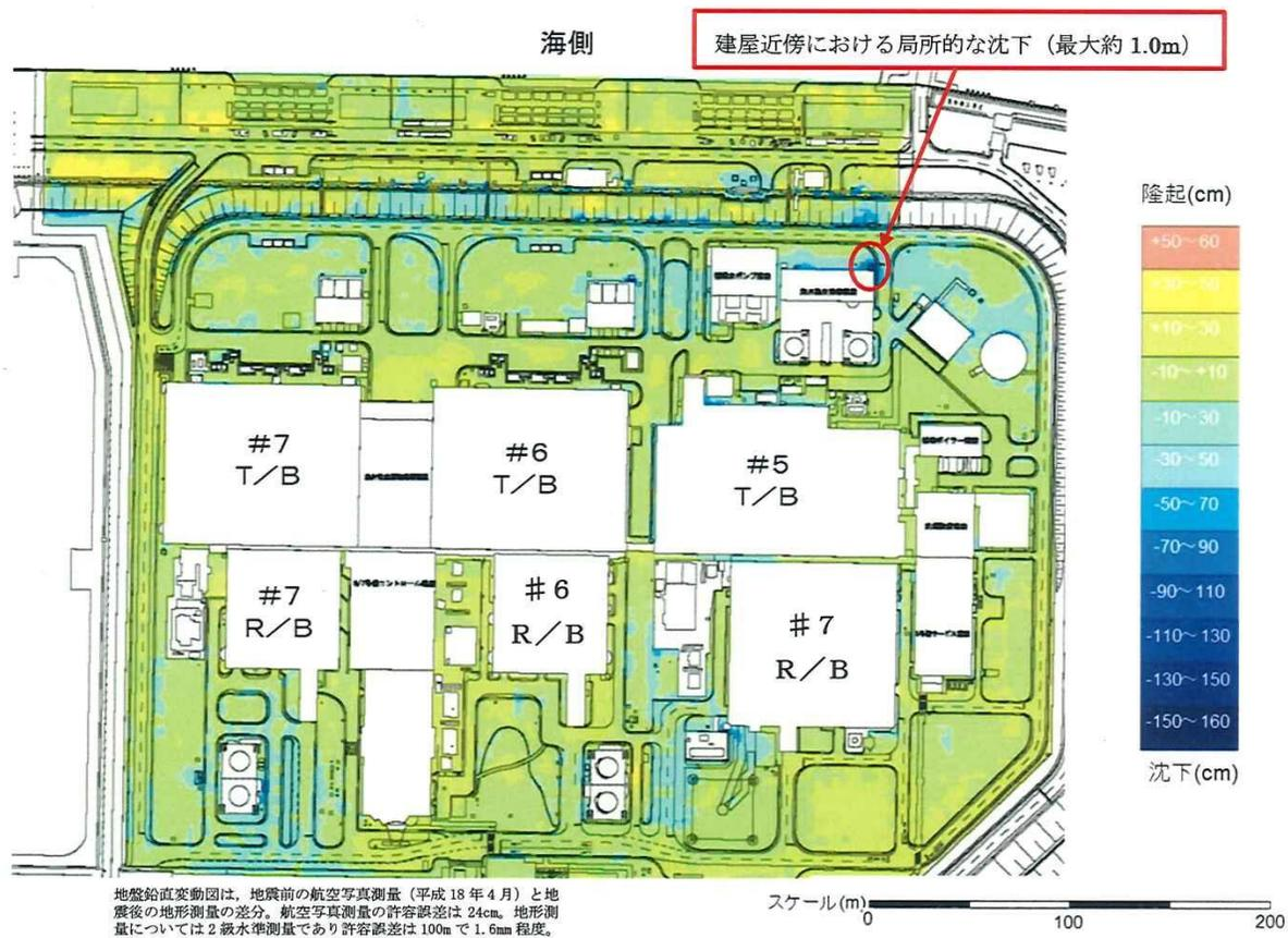
第 11.5.10 図 新潟県中越沖地震における敷地内の地盤鉛直変動図 (b)大湊側
